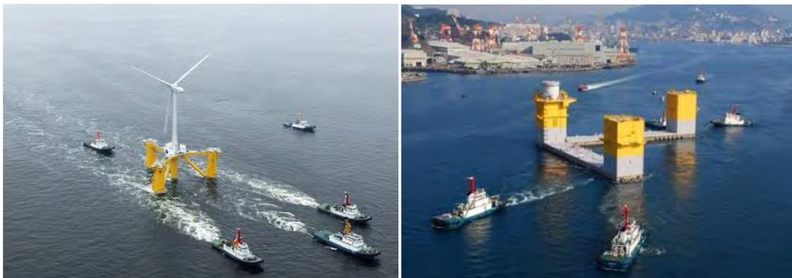
Figure 34 : Fukushima Mirai (2 MW-2013) et flotteur de Fukushima Shimpuu sans la turbine (7 MW-2015).
