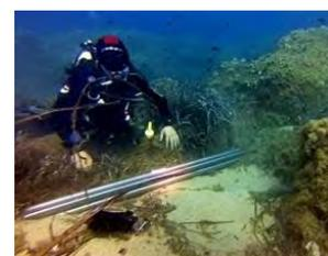
Figure 49 : Echangeur sonde immergé du système Nérée.
