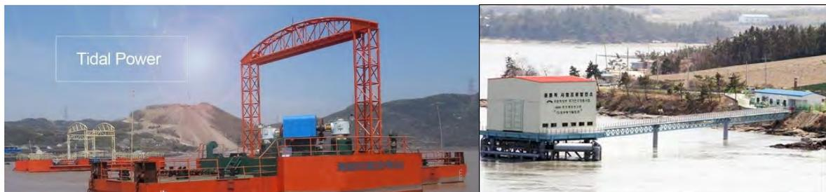
Figure 24 : barges Haineng III d'une puissance totale de 600 kW (Chine) et centrale hydrolienne d'Uldolmok de 1,5 MW en Corée du Sud
