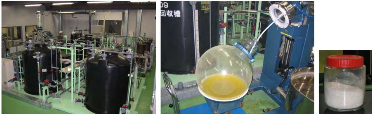
Figure 52 : Equipements d'extraction du lithium de l'eau de mer profonde à l'Université de Saga au Japon, solution de chlorure de lithium et précipité sec obtenus au bout de 150 jours d'opération. Source : Y. Ikegami - IOES, 2015.
