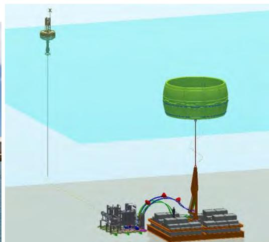
*Figure 84 : remorquage du flotteur du prototype CETO au Port-Ouest / vue d'ensemble du système CETO 4e génération déployé à la Réunion. Source : EDF EN*
