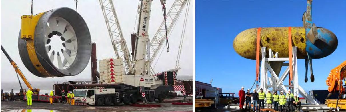
Figure 25 : hydrolienne Open Hydro 2 MW installée en Baie de Fundy, Canada, et hydrolienne Sabella 1,1 MW
