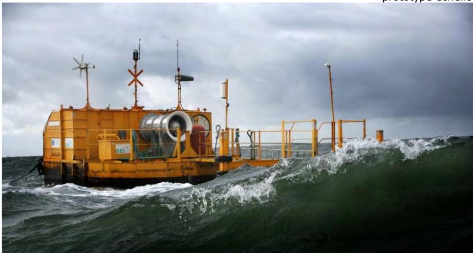
Système OWC sur plateforme flottante (« OceanEnergy buoy » développé par la société irlandaise New Wave Technologies Limited – prototype échelle 1/4)
