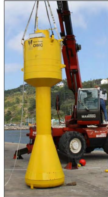
Système OWC flottant partiellement émergé (« SparBuoy » développé par l'Institut Technique Supérieur de l'Université de Lisbonne – prototype échelle 1/16<sup>e</sup>)
