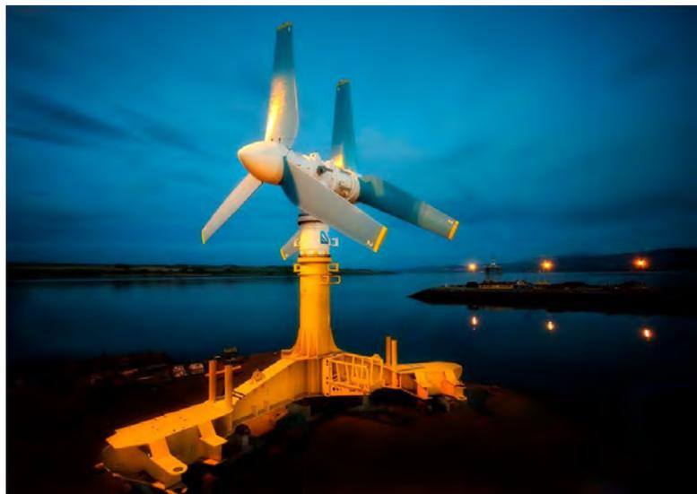
Figure 23 : Hydrolienne Andritz Hydro Hammerfest 1,5 MW et hydrolienne Atlantis Ressource 1,5 MW
