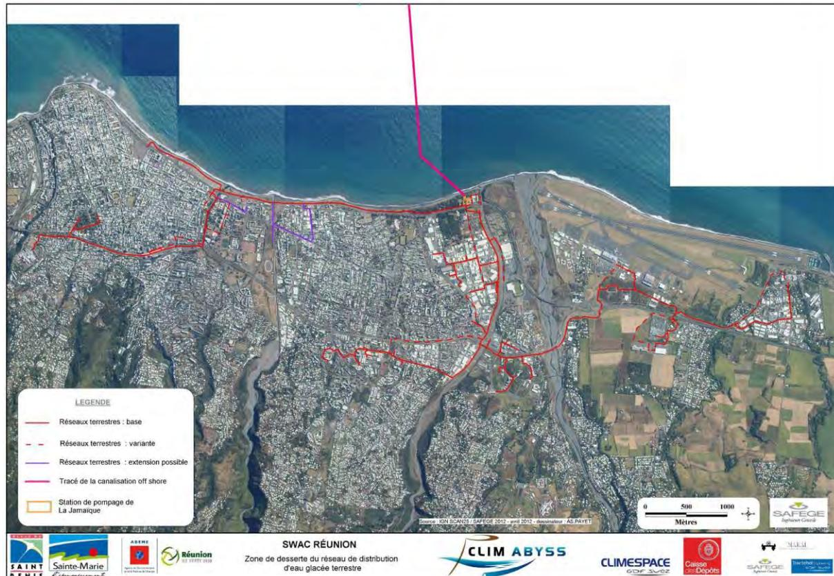
Figure 93 : plan du réseau urbain de climatisation du SWAC Nord du SIDEO. Source : Climabyss avril 2012.
